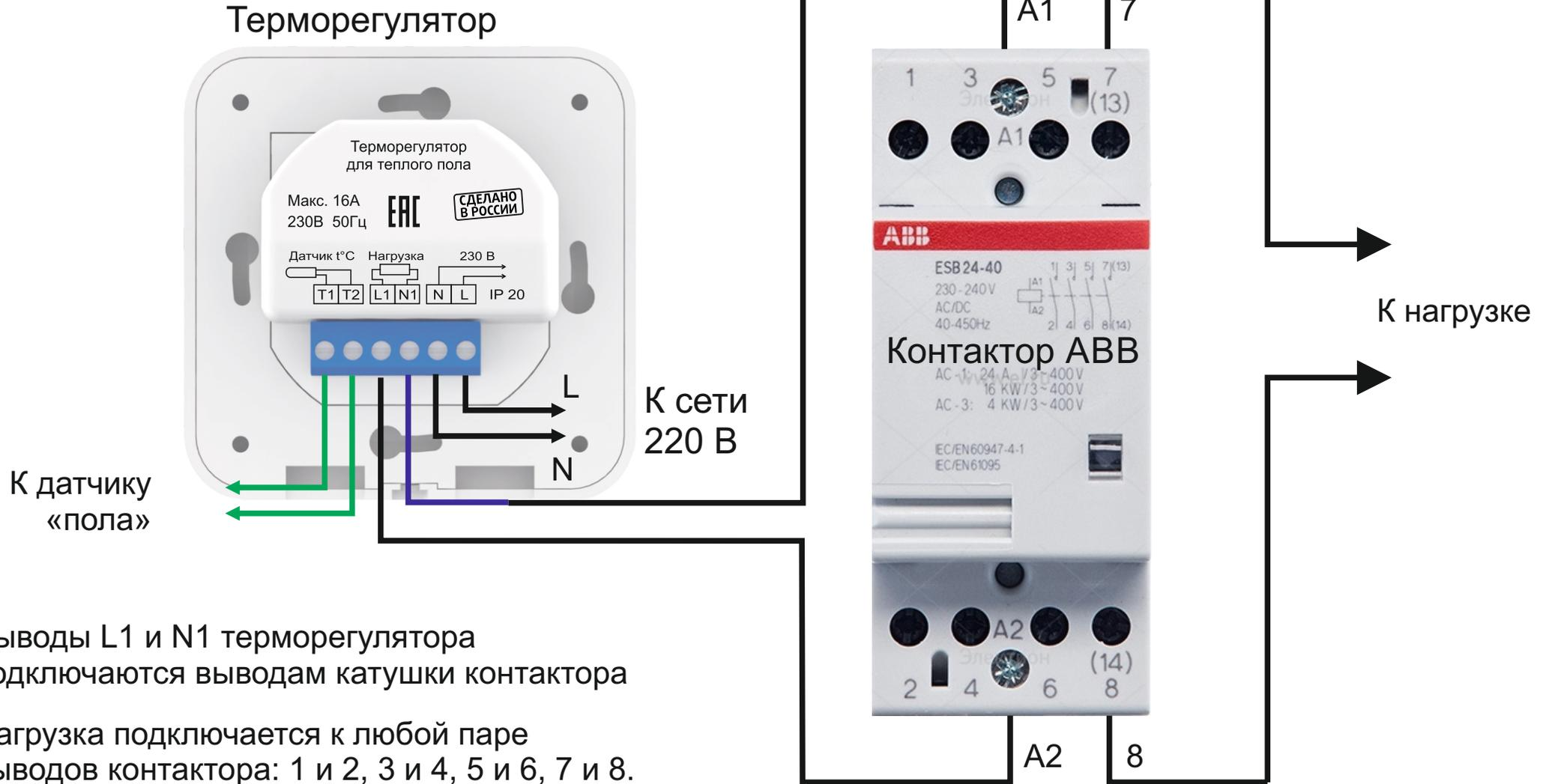
Выводы L1 и N1 терморегулятора подключаются выводам катушки контактора
